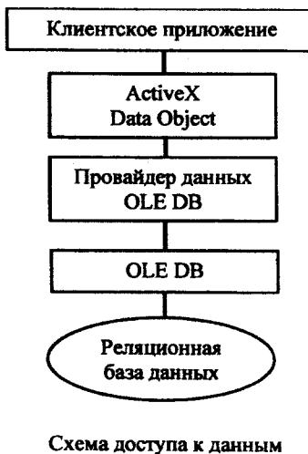
Технологии ADO значительно упрощают процесс организации совместного доступа и разработку приложений обработки баз данных для работы в локальных и глобальных сетях предприятия.
